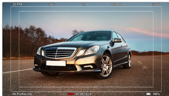
外接显示器上设置的SDI/HDMI叠加
